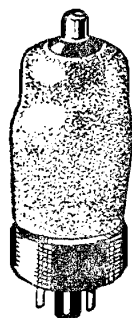
Двойной триод с общим выводом от катодов
